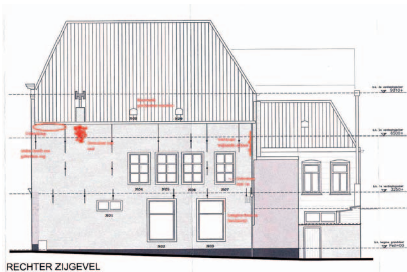
Rechterzijgevel, met in het rood de bouwkundige gebreken. (tekening: Architectenbureau Rokus Visser)
